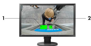
Een voorbeeld van maskeringen voor gegevensbeveiliging bij een geldautomaat: 1. gecamoufleerde pinpas, 2. gecamoufleerd toetsenbord
