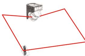
3. Vérifiez que les faisceaux laser sont dirigés vers les zones souhaitées et qu'il n'y a pas d'obstacles dans la zone de détection.
