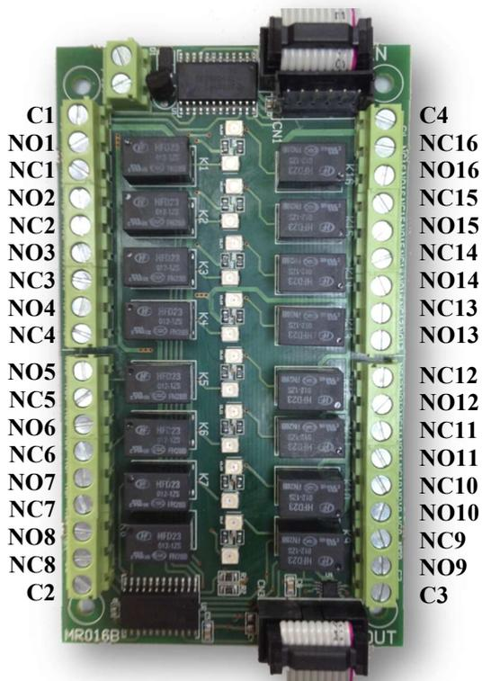
La condition d'utilisation des contacts indiquée sur la platine (NC, NO) se réfère au relais en condition de repos, si les relais sont activés la condition de fonctionnement s'inverse.
