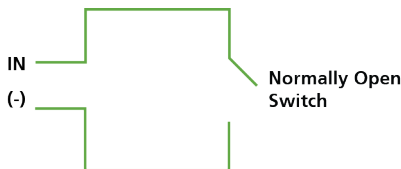
Figure 23: Connexion d'entrée normalement ouverte
