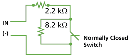
Figure 28: Entrée supervisée normalement fermée (double résistance)
