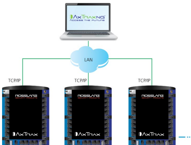
Figure 29: Connexion de plusieurs panneaux AC-825IP au serveur AxTraxNG
