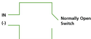
Figure 9: Connexion d'entrée normalement ouverte
