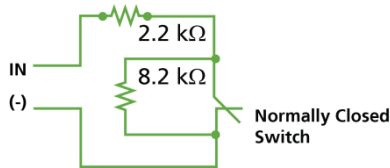
Figure 14: Connexion d'entrée supervisée normalement fermée (double résistance)
