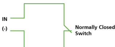
Figure 10: Connexion d'entrée normalement fermée
