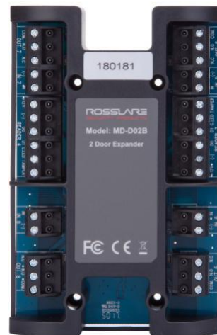
Figure 1: Carte d'extension du contrôleur d'accès MD-D02B
