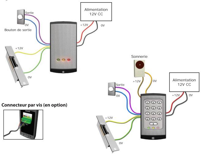
L'appareil doit être monté avec un boitier d'encastrement électrique pour obtenir l'espace nécessaire pour le connecteur. Si une plaque d'adaptation (310-750-F) est fixé, les fixations du boitier d'encastrement peuvent être utilisés.
