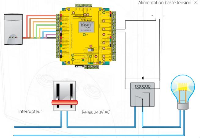
Le contrôleur Switch2 peut être utilisé pour la même fonction. En utilisant la carte de fonction, mettre l'unité en mode basculement. Le relais secteur est câblé entre les terminaux COM/NO/NF selon le besoin.
