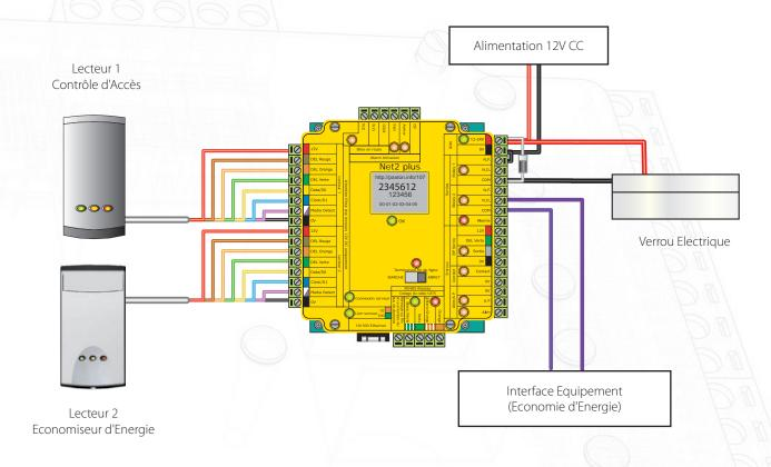
Le schéma ci-dessus montre comment une unité de contrôle peut être utilisé aussi bien pour le contrôle d'accès (Lecteur 1 - Relais 1) et l'éconmie d'énergie (Lecteur 2 - Relais 2).
