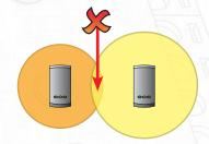
Lors de l'utilisation de lecteurs d'entrée et de sortie, les utilisateurs peuvent être détectés par les deux lecteurs lors du déplacement de l'utilisateur, ce qui gênera le fonctionnement du registre d'appel ou de l'Anti-Passback. Pour optimiser la fiabilité et la distance de lecture, vérifier que les lecteurs sont assez éloignés l'un de l'autre.
