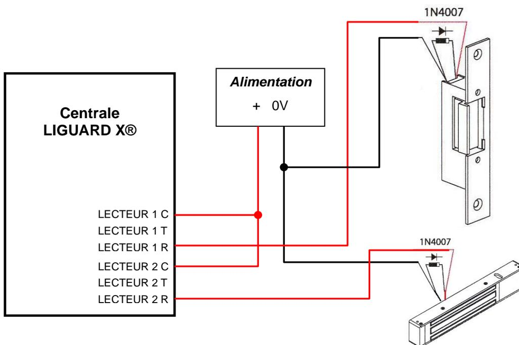
b. Gâche standard : fonctionnement à émission de tension
