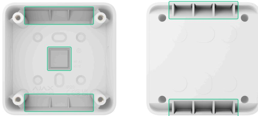
**Per instradare il cavo dal lato, dalla parte superiore o inferiore**, puoi rompere una delle sei sezioni nella parte superiore o inferiore del dispositivo o utilizzare la fessura laterale evidenziata nell'immagine. Utilizzare le pinze per staccare una sezione della custodia del dispositivo o praticare il foro nelle aree evidenziate, tenendo conto delle dimensioni del tubo, del tubo corrugato, della canalina portacavi o dei cavi.
