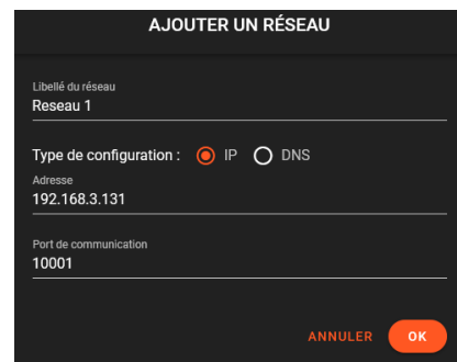
Fig. 9 : Création d'un réseau nommé 'Réseau 1'.
