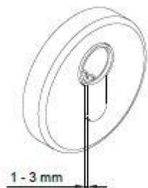
3. Uniquement pour les cylindres fournis sous forme de composants uniques : Lors de l'installation initiale, déposez 1 à 2 gouttes (max. 0,1 ml) d'huile non-résineuse dans les corps de cylindre avant de les monter sur le module de bouton. Il ne faut pas pulvériser directement dans le corps de cylindre avec une bombe aérosol.
