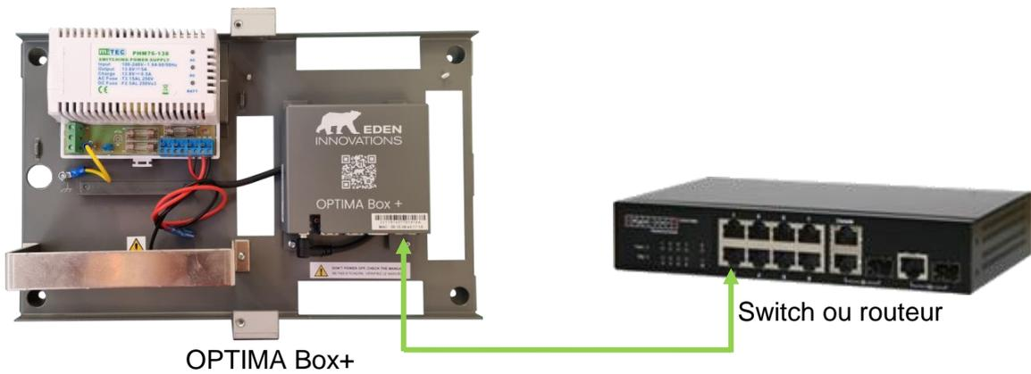
Veuillez utiliser un câble de type RJ45 Cat5e FTP blindé (ou F/UTP blindé).
